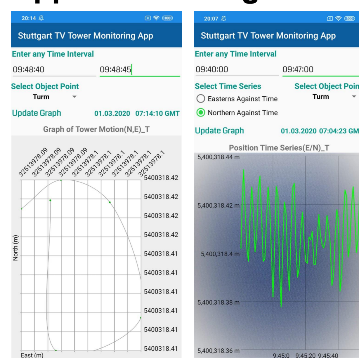
Links oben: Android App mit Visualisierungen zur Turmbewegung, basierend auf GOCA FIN-Dateien. Rechts oben: GOCA-Objektzeitreihen der App auf Basis der FIN-Dateien
