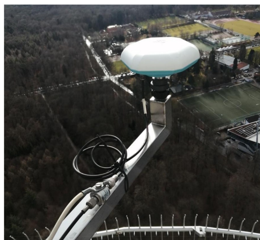
Links oben: GNSS Neuinstallation einer Multi-GNSS-Multi-Frequenz NavXperience-Antenne. Oben rechts: „Peak“ im Frequenzspektrum bei 0.2 Hz, der Grundschiwingung (Umlaufdauer T= 5 sec). Die Amplitude der Grundschiwingung liegt bei mittlerer Windstärke bei 6 cm
