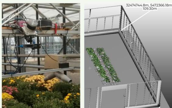
Links: Aufbau des MITESENS FC Subsystems (RGB-, Multispektral-Kamera, Laser, IMU) für Großversuch LVG 11/2022 auf Belüftungsschlitzen; ETRF89-Georeferenzierung über Apriltags-Marker. Rechts: ETRF89 BIM Modell mit exempl. (N,E,h) 3D-Koordinatengaben aus Laserscanningdaten. ETRF89 georeferenzierte 3D Voxel-punktwolke des Pflanzenbestandes aus RGB-Kameradaten. Bild und Graphik: HKA
