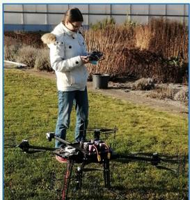
Links: Multikopter UAV mit MITESENS Flight Control (FC). Aufbau der FC mit Bordcomputer Jetson TX2, PIX4D-Sensorboard und Kameras. IEEE1588 Zeitsynchronisation und GNSS/MEMS/Optik basierte Navigationszustandsvektor  $y(t)$  auf FC im ETRF89/ITRF.  $y(t)$  basierte PID Fernsteuerung und intelligente autonome MPC (Model Predictive Control) Flugsteuerung über Ground Control (GC).
